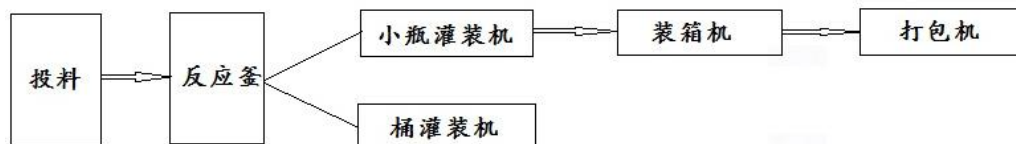
图 2-4 年产 3 万吨液体肥生产线工艺流程及产污环节图
