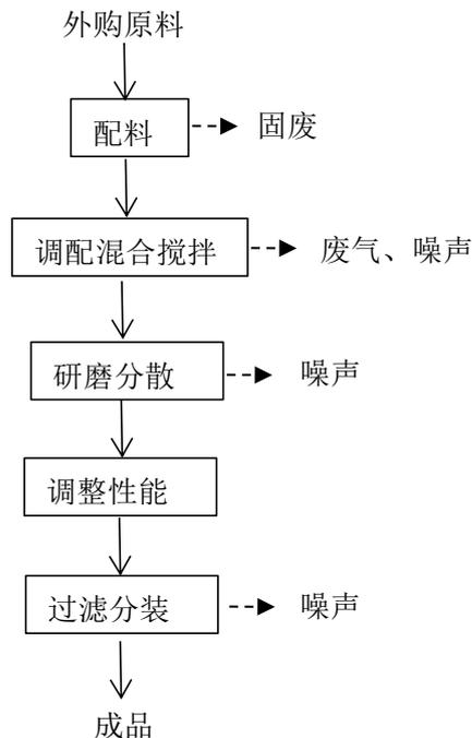
**图 2-4 防水防腐涂料生产工艺及产污节点图**
