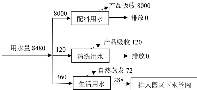
图 2-2 项目水平衡图 (m<sup>3</sup>/a)
