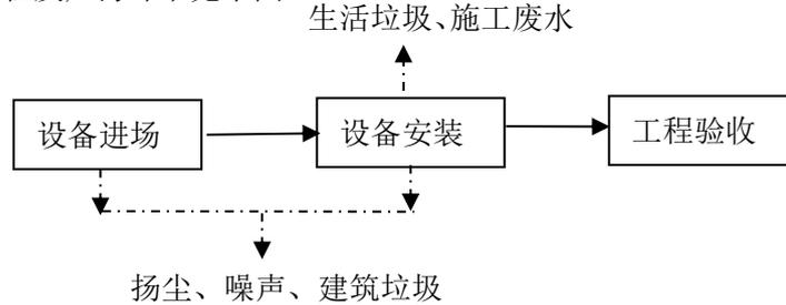
图 2-3 主体工程工艺流程及产污环节图
